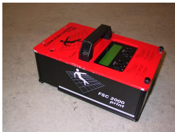
Abbildung 5 Messung am Bauwerk mit einem mobilen Gleitmessgerät
