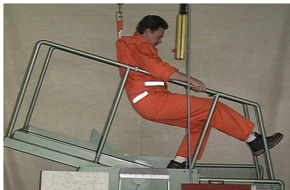
Abbildung 4 Begehungsverfahren (Schiefe Ebene)
